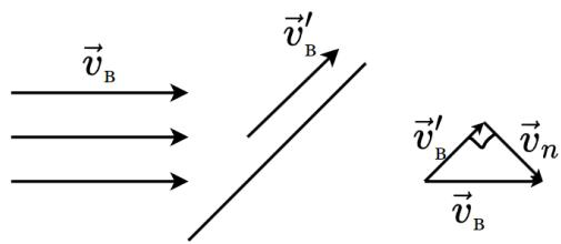
То есть воздух передаёт часть импульса  $mv_n$  машине. Для объёма  $V$  эта часть импульса создаёт силу:
