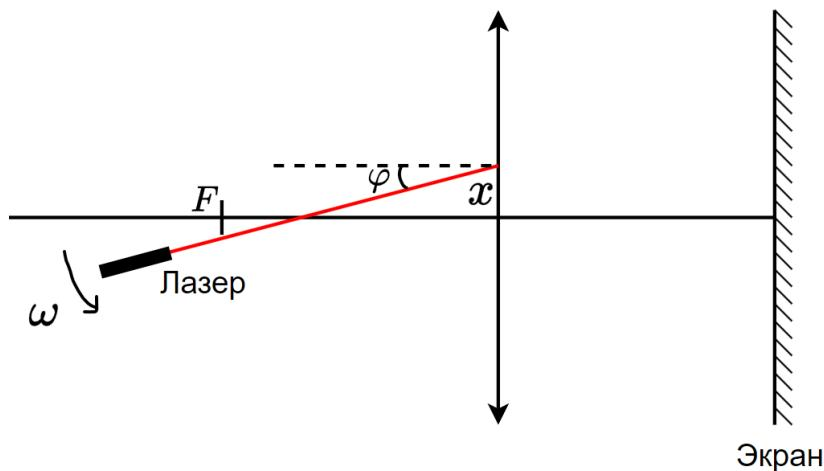
Играясь с лазером, Алишер собрал некую оптическую систему, изображённую на рисунке ниже. Лазер светил параллельно главной оптической оси на расстоянии  $x$  от неё на собирающую линзу, в результате чего получал точку на экране, расположеннном в фокальной плоскости линзы. Начав вращать лазер с угловой скоростью  $\omega$ , точка начала двигаться с некоторой скоростью.
