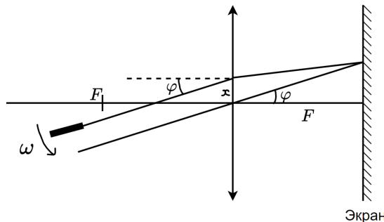
С помощью построения несложно заметить, что при любом расстоянии  $x$ , расстояние между точкой падения лазера и ГОО задаётся углом  $\varphi$  между лазером и ГОО:
